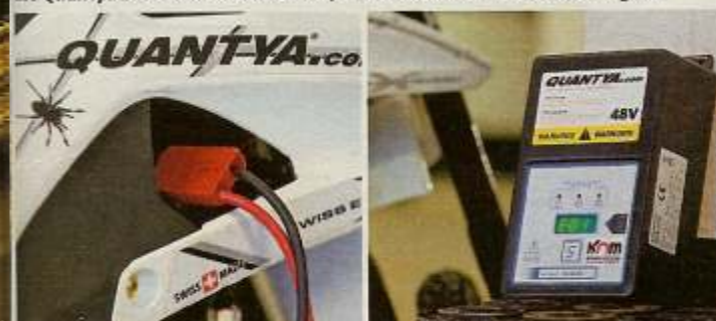
Über diesen Stecker fließt der Strom in die Batterie. Vom Lithium-Polymer-Akku ist absolut nichts zu sehen. Das Ladegerät gehört zu jeder Maschine, es wurde gerade überarbeitet. Vollladen dauert etwa 1,5 Stunden
