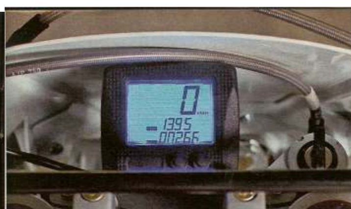
Digitale Anzeige wie bei ganz normalen Zweirädern. Je nach Übersetzung läuft die Quantya zwischen 60 und 80 km/h – für die Stadt reicht das völlig aus
